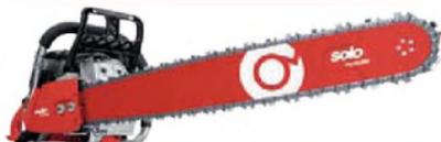
Модель экстра-класса: мощность 4,7 кВт, рабочий объем 80,7 см<sup>3</sup>, высочайший уровень производительности при удельном весе всего лишь 1,4 кг/кВт и максимальный уровень надежности. Также стоит упомянуть литой коленчатый вал, состоящий из 3 частей, легкость техобслуживания и пильную гарнитуру с шиной длиной 50 см и шагом цепи 3/8". В качестве альтернативы Вам предлагаются пильные шины различной длины – от 45 до 70 см.
